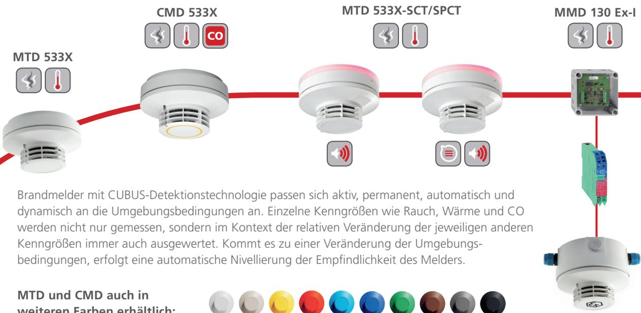
Brandmelder mit CUBUS-Detektionstechnologie passen sich aktiv, permanent, automatisch und dynamisch an die Umgebungsbedingungen an. Einzelne Kenngrößen wie Rauch, Wärme und CO werden nicht nur gemessen, sondern im Kontext der relativen Veränderung der jeweiligen anderen Kenngrößen immer auch ausgewertet. Kommt es zu einer Veränderung der Umgebungsbedingungen, erfolgt eine automatische Nivellierung der Empfindlichkeit des Melders.
